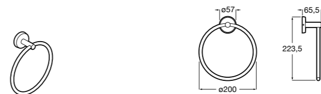
Twin 816711001 Полотенцедержатель в форме кольца. Крепление на болты или клей.
